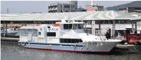
笠岡港には高速旅客船「しおじ」が停泊中でした。ツネシクラフト&ファシリティーズが建造したアルミ船で、19 総トン、23.5 ノットです。
